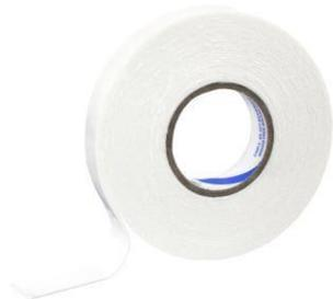
Fita produzida com espuma de polietileno de célula fechada revestida em ambos os lados com adesivo acrílico base solvente. Possui excelente resistência a compressão, boa resistência aos raios ultravioleta e umidade.
