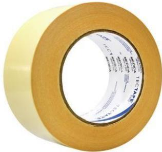
Fita produzida com tecido-não-tecido (TNT), revestido em ambos os lados com adesivo acrílico base solvente. Possui excelente adesão inicial, ótima resistência a altas temperaturas, ótima resistência aos plastificantes e ao envelhecimento.
